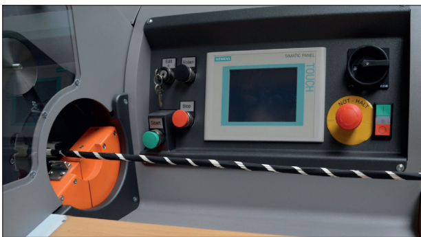
Das Leistungsspektrum umfasst u.a. das Bandagieren und Bündeln von Kabelbäumen an den hauseigenen Maschinen.
